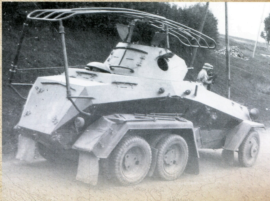
★ Броневых автомобиль Sd.Kfz.232 (6-Rad). Хорошо видны все узлы крепления антенны.
